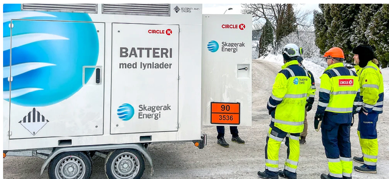
Skagerak energi utvidet porteføljen av mobile batterier i 2024, og lanserte batteri og lynlader på hjul. Disse er tilpasset anleggsplasser med mindre energibehov og/eller dårligere fremkommelighet.
